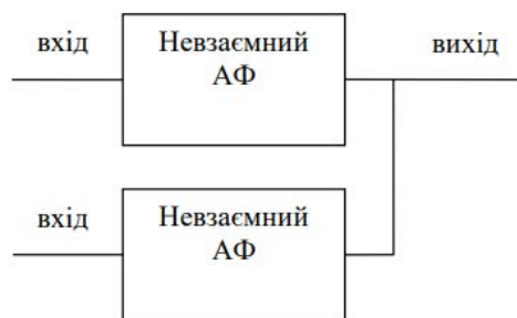
Рис. 8. Блок схема НВЧ – комутатора на два канали
